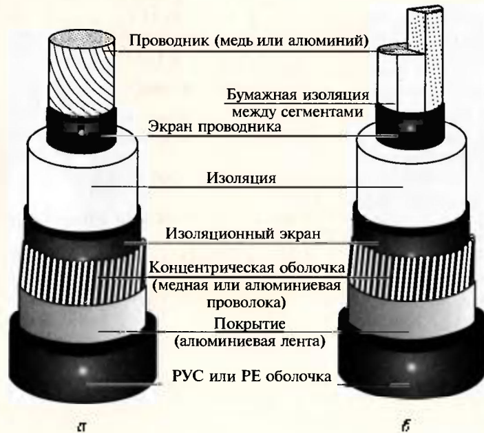
Рис. 14.15. Одножильные кабели напряжением 220...500 кВ с изоляцией из сшитого полиэтилена с медной или алюминиевой жилой:
