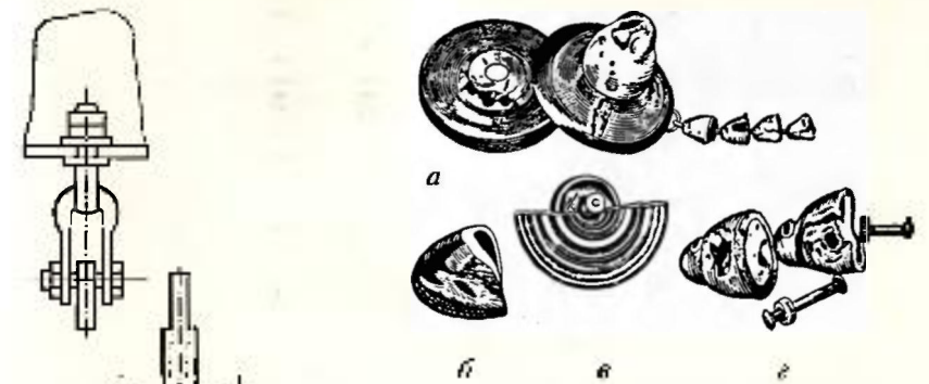
Рис. 13.13. Повреждения изоляторов: a — ожоги глазури и оплавление металлических деталей; b — разрушение фарфора; c — разрыв шапки; z — прогорание шапки
