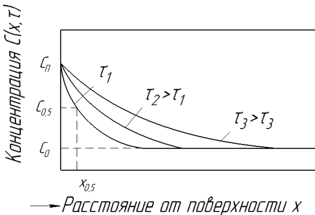
Рис. 7.1. Распределение концентрации в однофазной зоне диффузионного обогащения в разные моменты времени при постоянной концентрации на поверхности C_n
