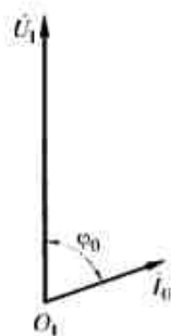
Рис. 4.20. Векторная диаграмма асинхронной машины в режиме холостого хода
