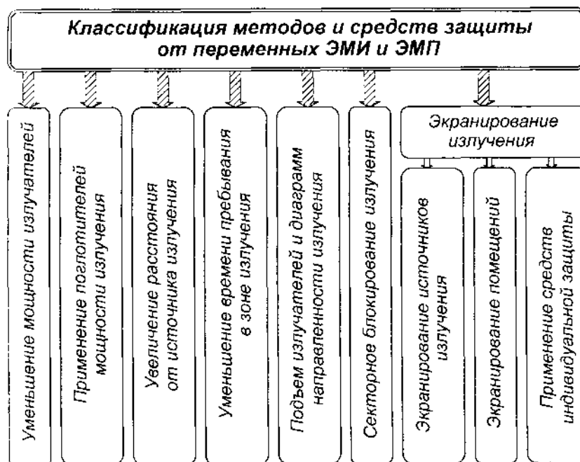
Рисунок 3.28 Классификация методов и средств защиты от переменных электромагнитных полей и излучений
