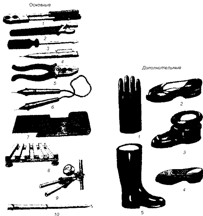
Рисунок 3.54 Электрозащитные средства для работы на электроустановках: основные: 1 — клещи для вставки предохранителей; 2 — гаечный ключ; 3 — отвертка; 4, 6, 10 — указатель напряжения; 5 — пассатижи; 7 — резиновый коврик и дорожка; 8 — изолирующая подставка; 9 — токоизмерительные клещи; дополнительные: 1 — перчатки резиновые диэлектрические; 2, 3 — галоши и боты диэлектрические; 4 — туфли антистатические; 5 — сапоги диэлектрические
