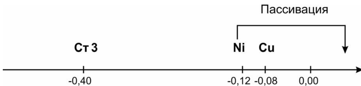
Рис. 2.1. Схема, иллюстрирующая соотношение потенциалов углеродистой стали (Ст 3), никеля и меди
