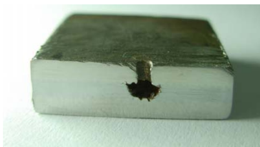
Рис. 3.2. Вид образца 08X18H10T – сталь 10 – 08X18H10T
