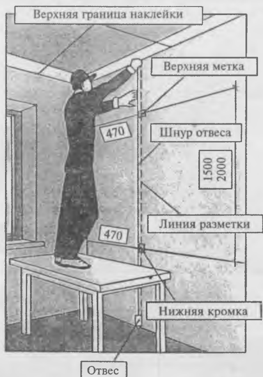
Рис. 52. Разметка и закрепление границ наклейки и первого полотнища
