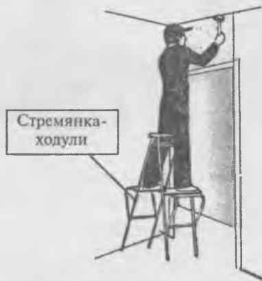
Рис. 84. Облицовка стены над дверным проемом
