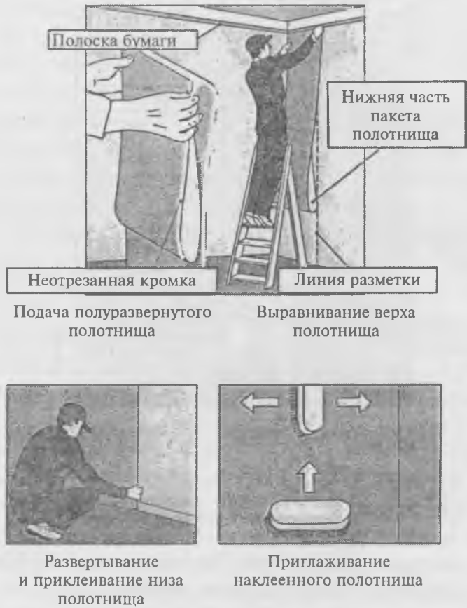
Рис. 53. Наклейка первого полотнища
