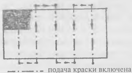
Рис. 67. Схема перемещения удочки краскораспылителя при окрашивании плоской поверхности
