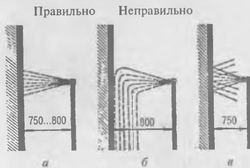
Рис. 38. Расположение форсунки относительно окрашиваемой поверхности:
