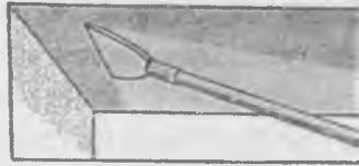
Очистка шпателем-скребком на удлиненной ручке
