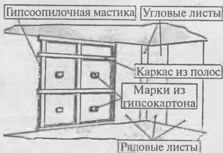
Устройство каркаса из полосок гипсокартонных листов
