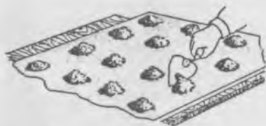
Нанесение лепок из гипсовой мастики на тыльную сторону листа
