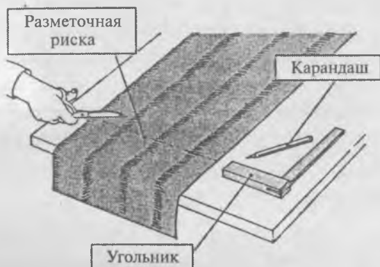
Рис. 50. Раскрой полотнищ по длине
