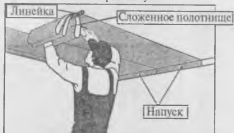
Оклеивание потолка одним человеком
