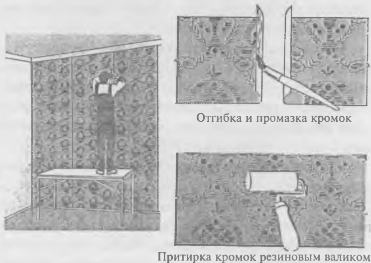
Рис. 57. Проклейка кромок наклеенных полотнищ
