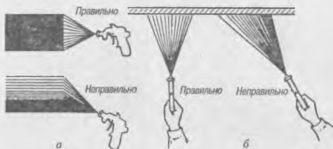
Рис. 43. Правильное и неправильное положения краскораспылителя при окраске поверхностей:
