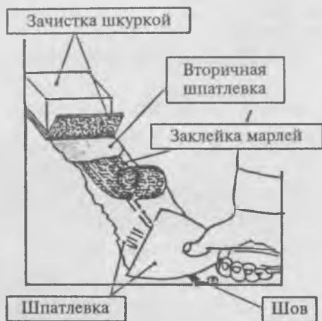
Рис. 45. Заделка стыков
