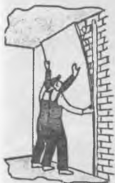
Установка листа на опорные марки и лепки
