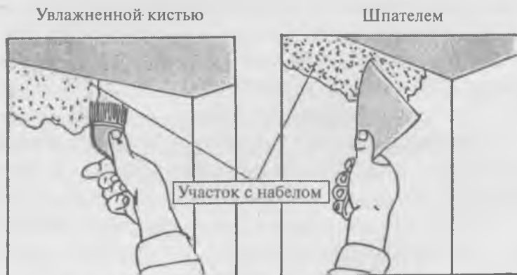
Рис. 44. Удаление набела с оштукатуренных стен
