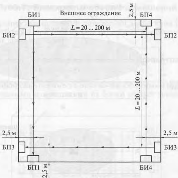
Рис. 7.44. Схема размещения двухпозиционных радиоволновых извещателей при защите замкнутого периметра:
