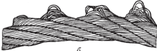
Рис. 11. Выдавливание проволок прядей: а — в одной пряди; б — в нескольких прядях
