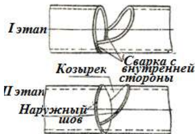
Рисунок 1.51 - Порядок сварки стыка труб с козырьком
