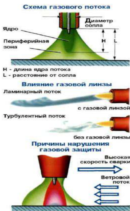
Рис. 16. Схема газового потока.
