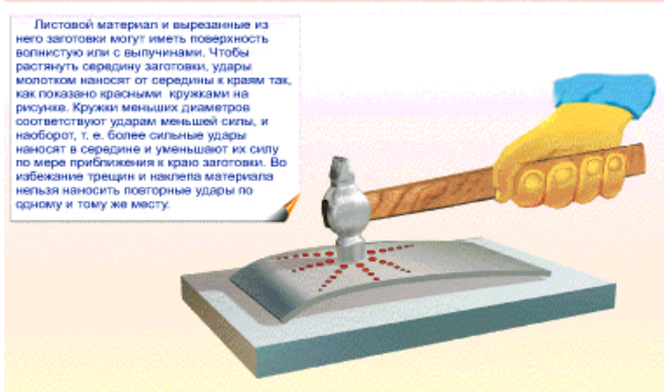
Правка и рихтовка металла. Распределение ударов при правке листа
