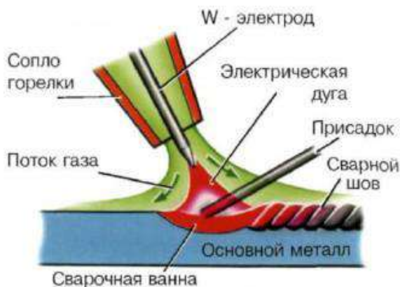
Рис. 2. Процесс сварки неплавящимся электродом в среде защитных газов
