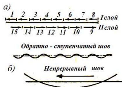
Рисунок 1.47 - Обратно - ступенчатый порядок наложения швов - а; сварка на проход - б
