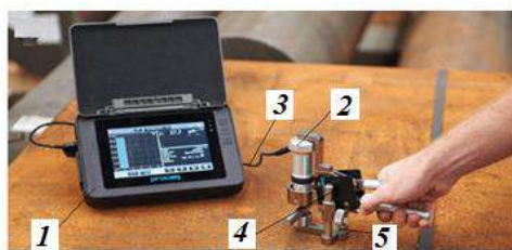
Рисунок 1.4 - Портативный твердомер Equotip 550 для измерения твердости по Роквеллу и Виккерсу: 1 - процессор; 2 - индентор; 3 - соединительный провод; 4 - ручка для закрепления индентора; 5 - плоская опора индентора;
