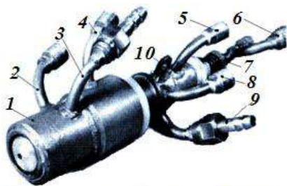
Рисунок 1.70 - Плазматрон для автоматической сварки алюминиевых сплавов на постоянном токе обратной полярности (минус на изделии) на токе до 500 А
