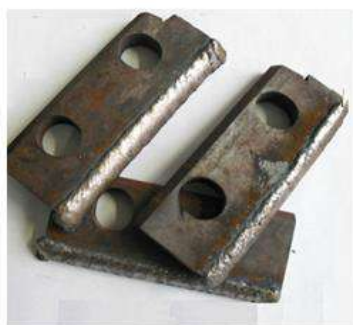
Рисунок 1.43 - Восстановление наплавкой кромок режущего инструмента
