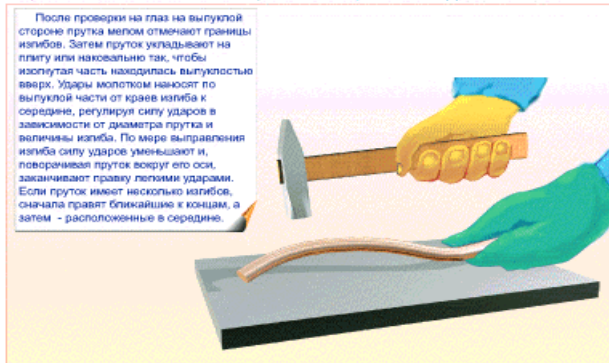
Правка и рихтовка металла. Правка цилиндрического прутка на плите.
