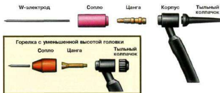
Рис. 8. Составные части горелки.
