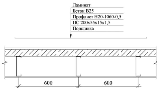
Рисунок А.1. Сечения по конструкции перекрытия
