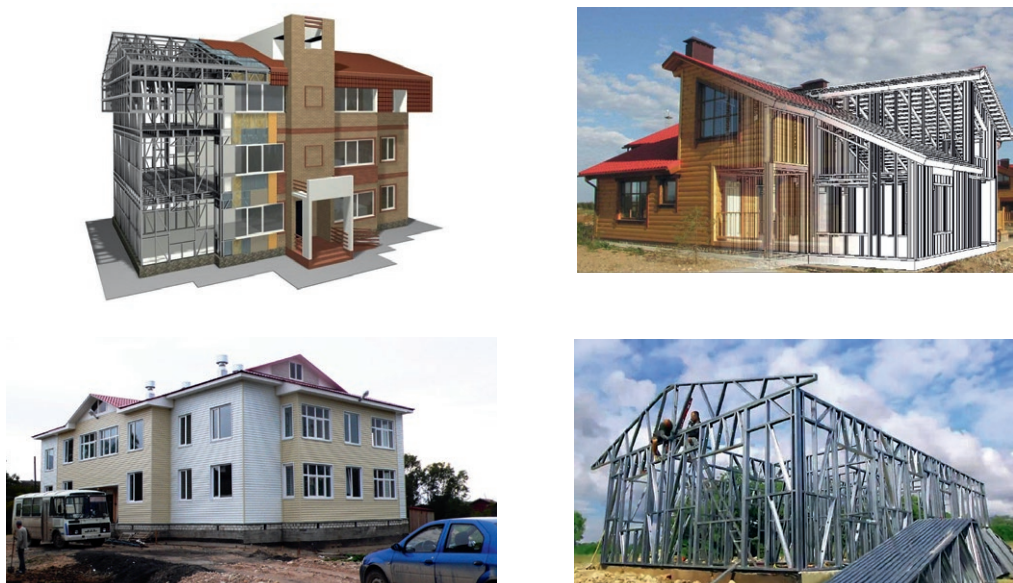
Рис. 5.1. Примеры малоэтажных зданий на основе каркаса ЛСТК
