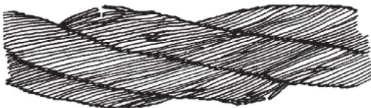
Рис. 1. Обрывы и смещения проволок каната крестовой свивки
