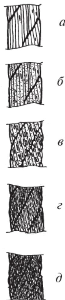
**Рис. 5. Поверхностная коррозия проволок каната крестовой свивки:**
