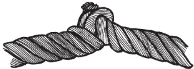
**Рис. 14. Перекручивание каната**
