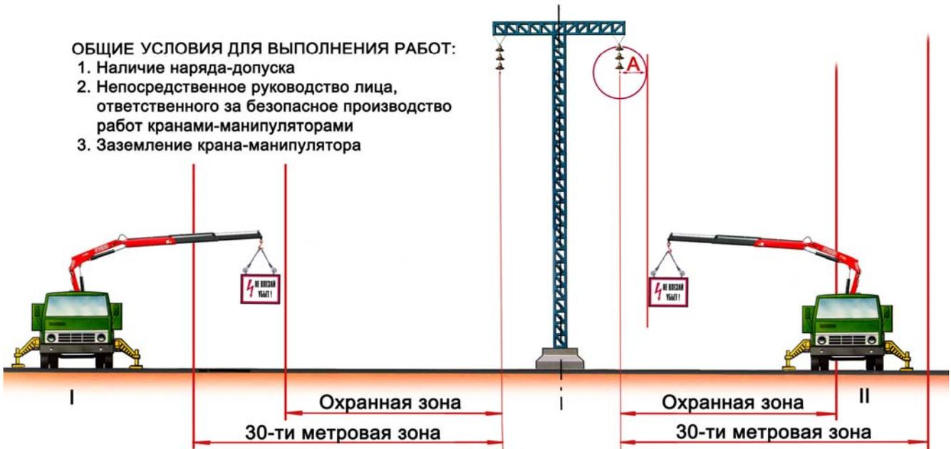
В случае производственной необходимости, если невозможно выдержать указанные расстояния, работа краном-манипулятором в охранной зоне может производиться при отключенной линии электропередачи по наряду-допуску, в котором указывается время проведения работ.
