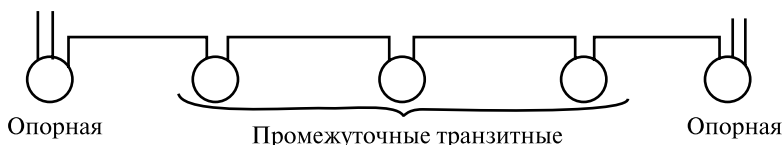
Рис. 8.2. Схема питания ТП по одноцепной ЛЭП
