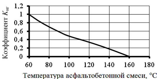
Рис. 4.7. Влияние коэффициента K_{нр} от нижнего температурного интервала горячей асфальтобетонной смеси
