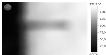
Рис. 3.10. Тепловое изображение участка покрытия после распределения асфальтобетонной смеси (температура воздуха 5 °С, температура основания 2...3 °С, начальная температура перед укладкой смеси в покрытие 165 °С, скорость ветра от 0 до 3 м/с)
