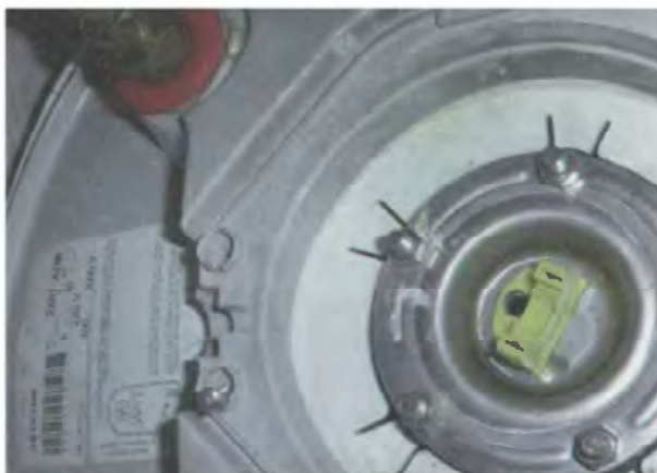
7. Смените прокладку и установите на место распределительную электрическую плату
