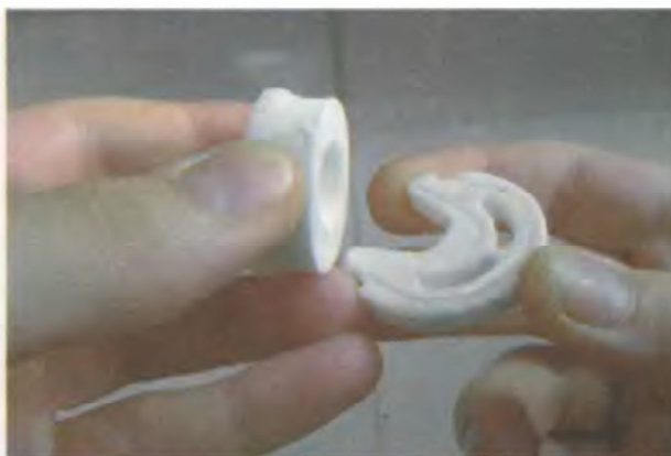
5. Проверьте состояние дисков и, если необходимо, замените их
