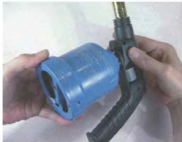
3. Навинчивайте на патрон горелку до тех пор, пока ее конец не проткнет патрон
