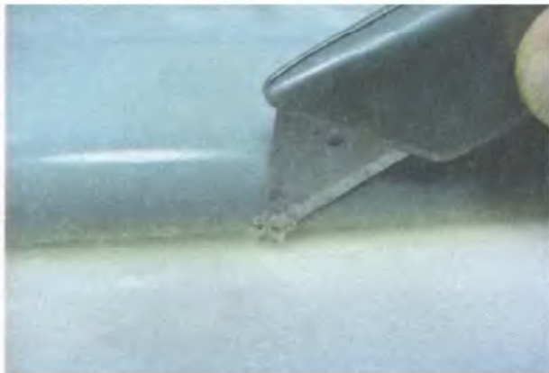
1. Срежьте герметик с одной стороны
