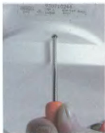
1. Отключите электропитание водонагревателя, затем отвинтите винт защитной крышки бака
