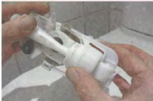
2. Разберите головку крана-полавка
