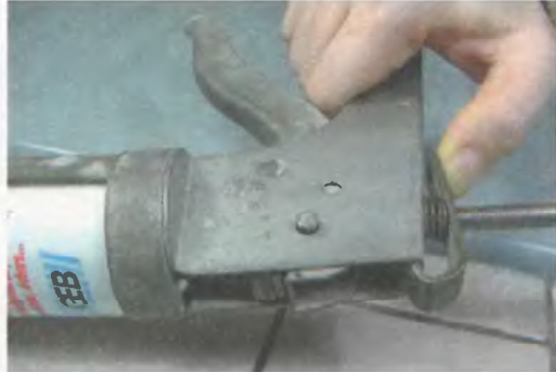
4. Заблокируйте пистолет, нажав на рычаг на его тыльной части
