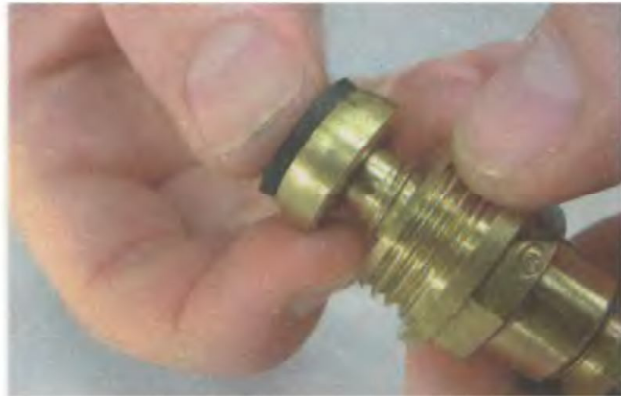
5. Вдавите прокладку в гнездо. Теперь ее уже нельзя вынимать
