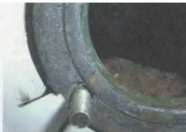
5. Проверьте состояние внутренних стенок бака и оцените количество осевшей на них накипи
