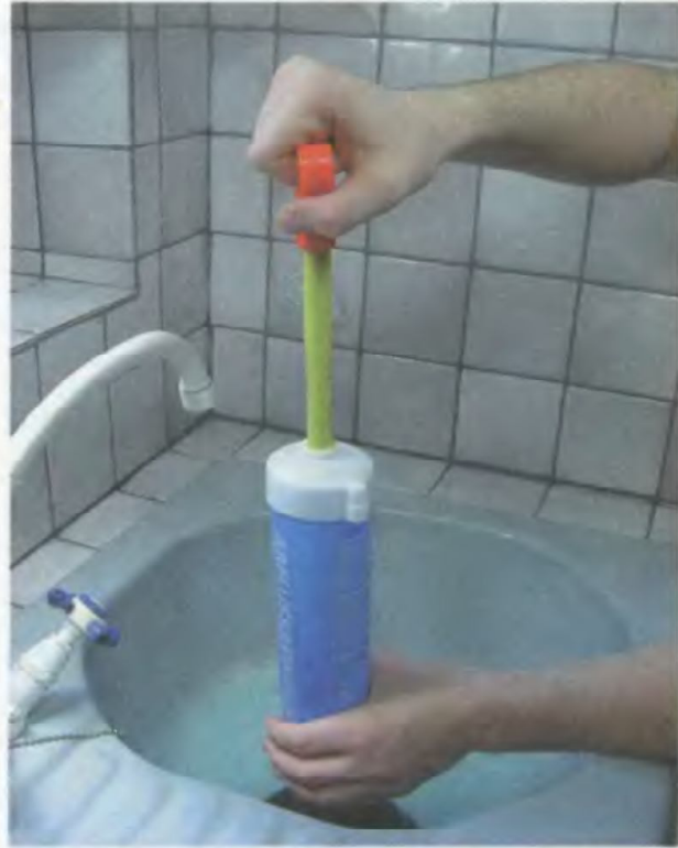
3. Качайте насос до тех пор, пока стоящая в раковине вода не уйдёт. Затем включите на некоторое время горячую воду
