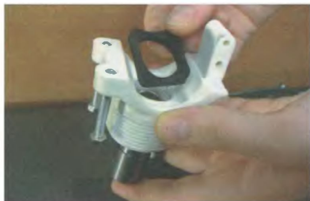
2. Установите уплотнительную прокладку верхней части хомута
