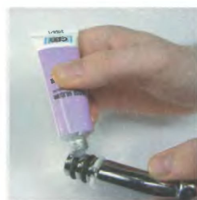
3. Нанесите на прокладки смазку или силикон, а затем снова соберите смеситель
