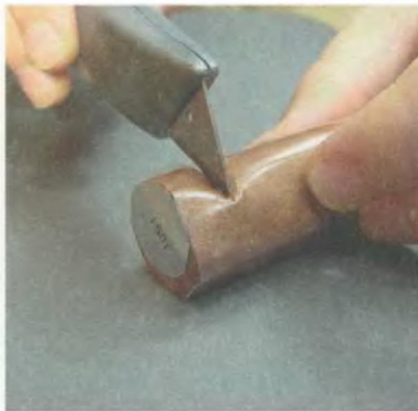
3. Отрежьте кусок двухкомпонентной мастики толщиной примерно в 1 см
