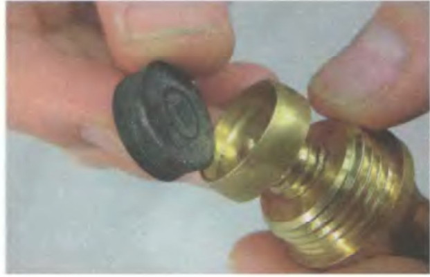
4. Замените прокладку на аналогичную (имеющую соответствующие диаметр и толщину)
