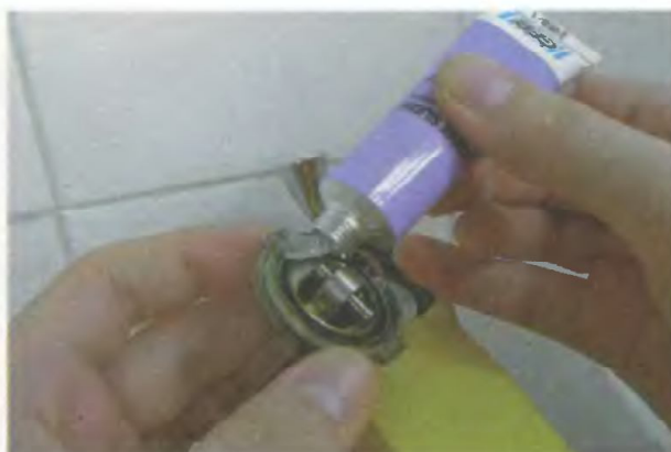
6. Нанесите на механические детали смазку или силикон. Не смазывайте керамические диски!
