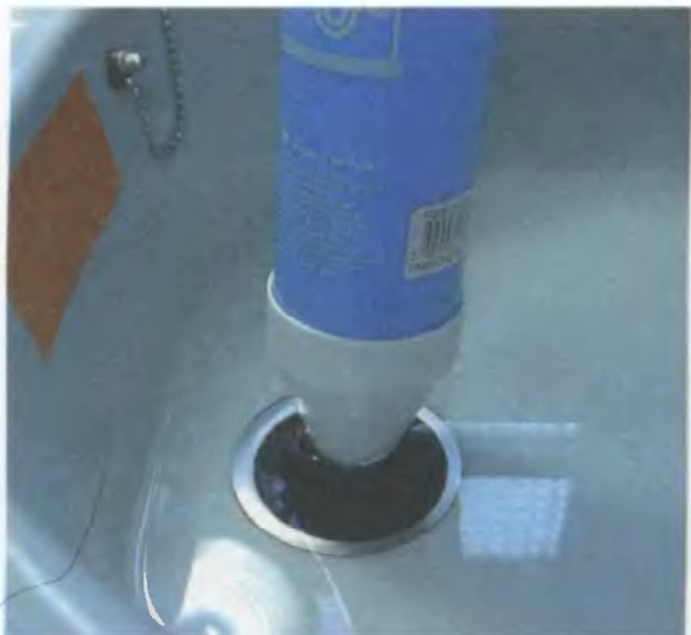
4. Чтобы увеличить давление, можно использовать присоску меньшего диаметра
