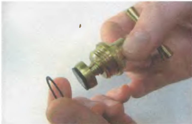
2. Снимите герметизирующую прокладку. Если она повреждена, замените ее новой
