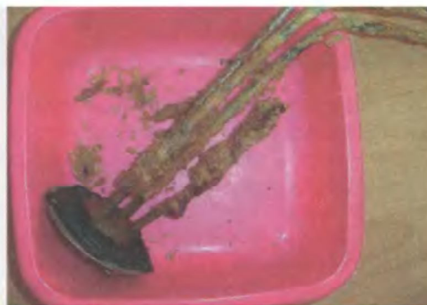
4. Выньте из бака старый нагревательный элемент
