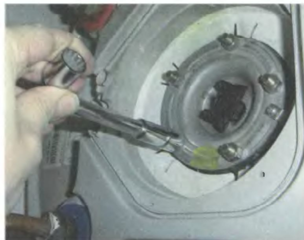
3. Отвинтите распределительную электрическую плату
