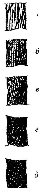
Рис. 6. Поверхностная коррозия проволок каната крестовой свивки:
