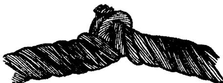
Рис. 15. Перекручивание каната
