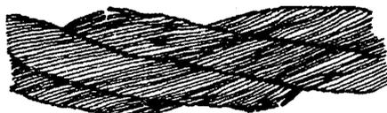
Рис. 1. Обрывы и смещения проволок каната крестовой свивки
