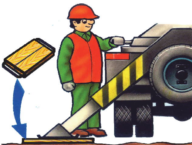
Рис. 12. Установка подъемника на опоры
