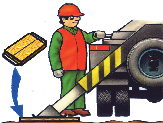
Рис. 12. Установка подъемника на опоры
