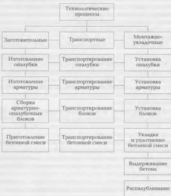
Рис. 11.1. Схема технологического процесса возведения монолитных железобетонных конструкций
