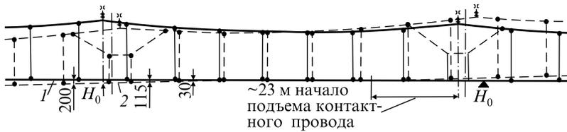
Рис. 3.30. Расположение проводов цепных подвесок в переходном пролете трехпролетного сопряжения анкерных участков
