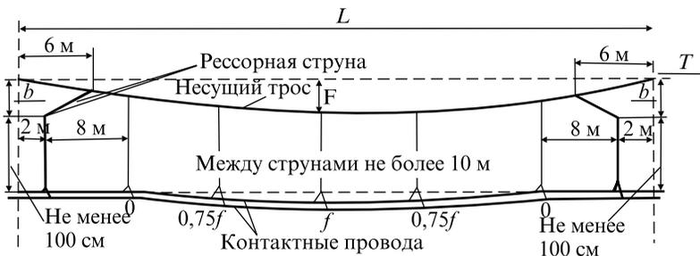
Рис. 13.25. Схема промежуточного пролета полукомпенсированной подвески с двумя контактными проводами
