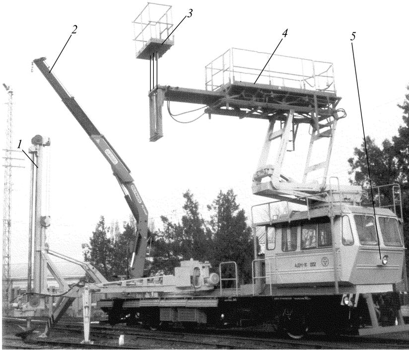
Рис. 15.8. Автомотриса АДМ-1С: 1 — буровая установка; 2 — кран-манипулятор; 3 — телескопическая вышка; 4 — неизолированная рабочая площадка; 5 — кабина
