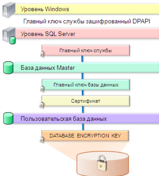
Рис. 9.37. Архитектура шифрования данных в SQL Server 2008
