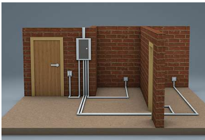
Рисунок 2.2.4.7. Вид прокладки кабеля и проводов под полом.
