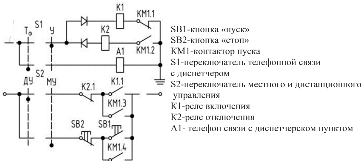
Рисунок 2.3.3.10 Элементы схемы управления пуском и остановкой конвейера на пульте местного управления
