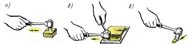
Рис. 137. Рабочие приемы паяния: а — зачистка ребра паяльника на куске напильника, б — припаивание одной детали к другой, в — взятие припоя на ребро паяльника
