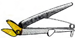
Рис. 63. Ножницы для резки асбестоцементных листов и плиток
