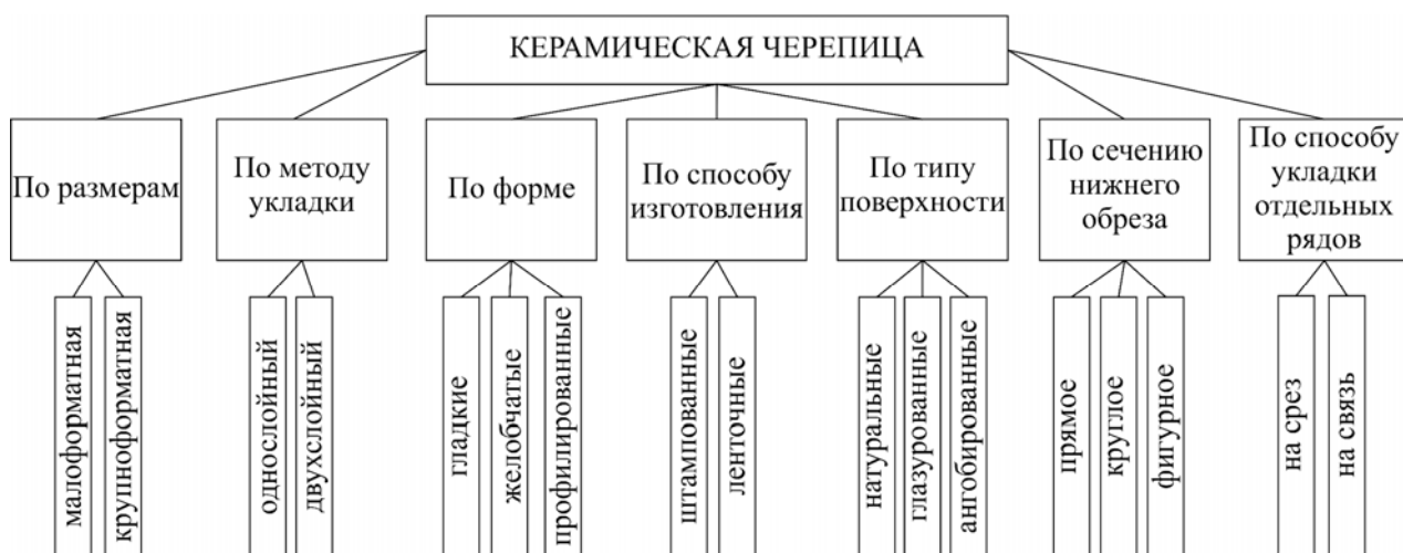
Рис. 2. Классификация керамической черепицы
