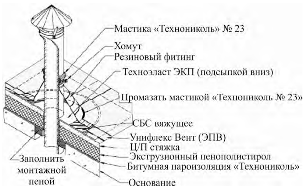
Рис. 60. Сопряжение кровельного ковра с трубами
