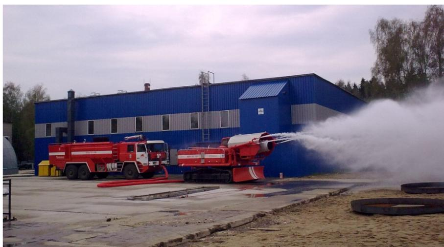
Рис. 7.104. Общий вид мобильного пожарно-спасательного комплекса большой мощности, оснащенного роботизированной установкой газовойодяного тушения
