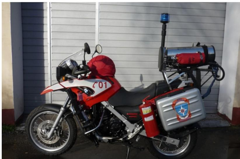
Рис. 7.113. Пожарно-спасательный мотоцикл ПСМ-1 на базе BMW G 650 GS
