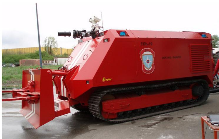
Рис. 7.103. Мобильный роботизированный комплекс пожаротушения тяжелого класса ЕЛЬ-10
