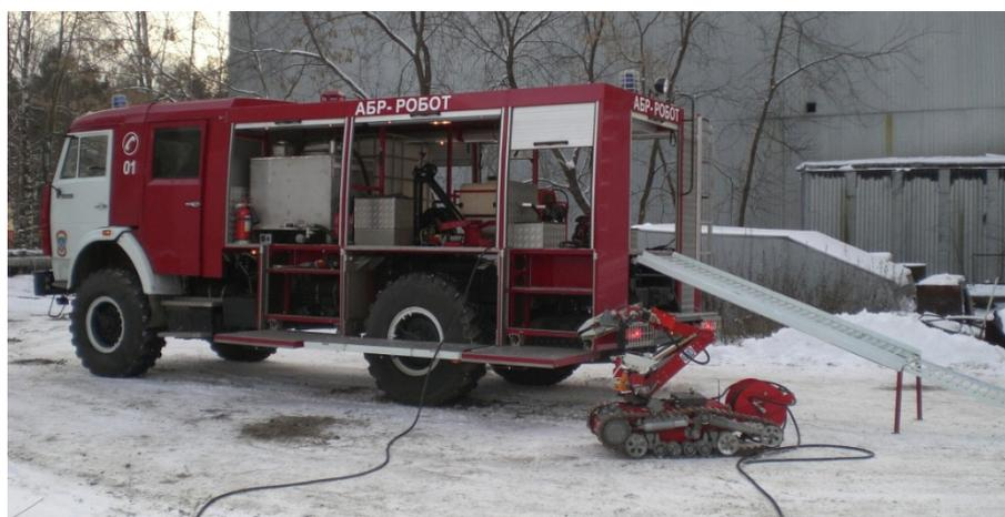
Рис. 7.101. Общий вид АБР-РОБОТ и МРК-РП
