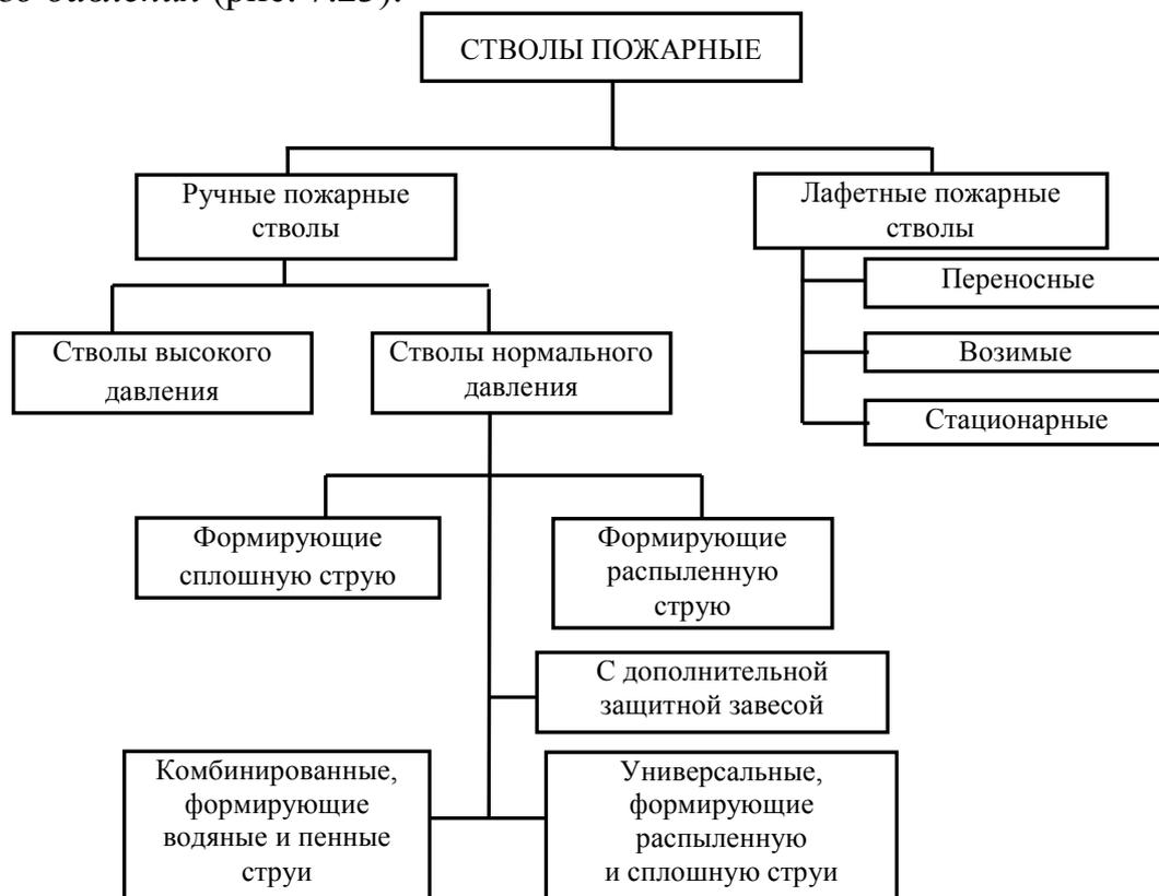
Рис. 7.23. Классификация пожарных стволов
