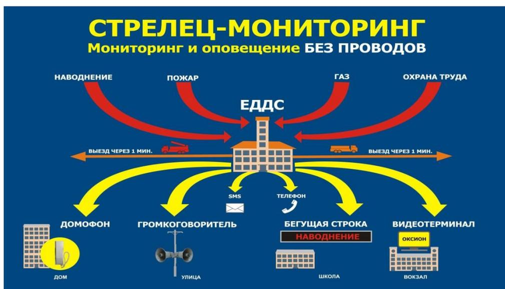
Рис. 8.3. Функциональные возможности ПАК «Стрелец-Мониторинг»
