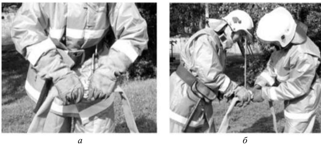
Рис. 8.23. Соединение головок напорного пожарного рукава:
