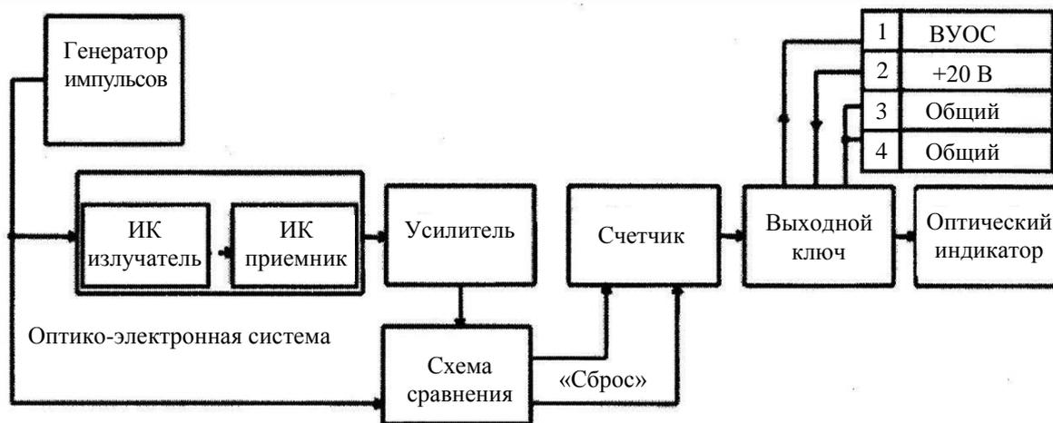
Рис. 6.3. Структурная схема извещателя ИП 212-45
