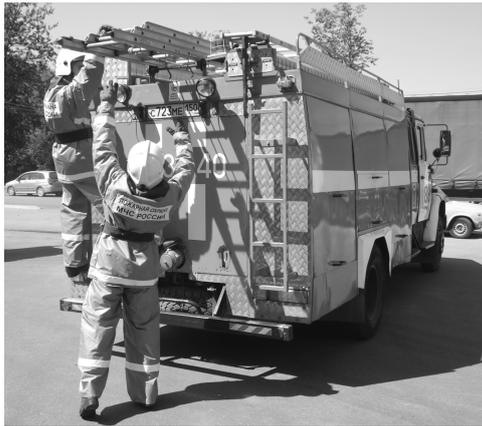
Рис. 8.50. Снятие ВЛ с автомобиля
