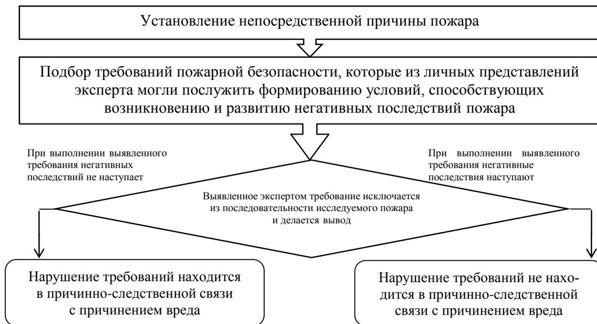
Рис. 3.1. Блок-схема алгоритма метода мысленного исключения
