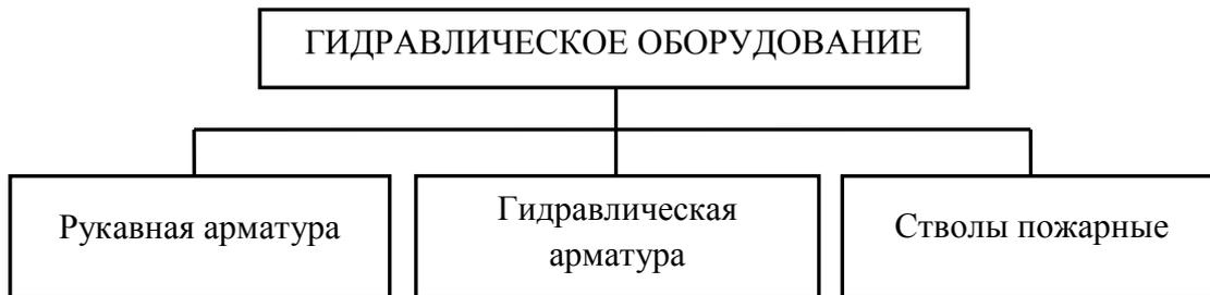
Рис.7.22. Классификация гидравлического оборудования
