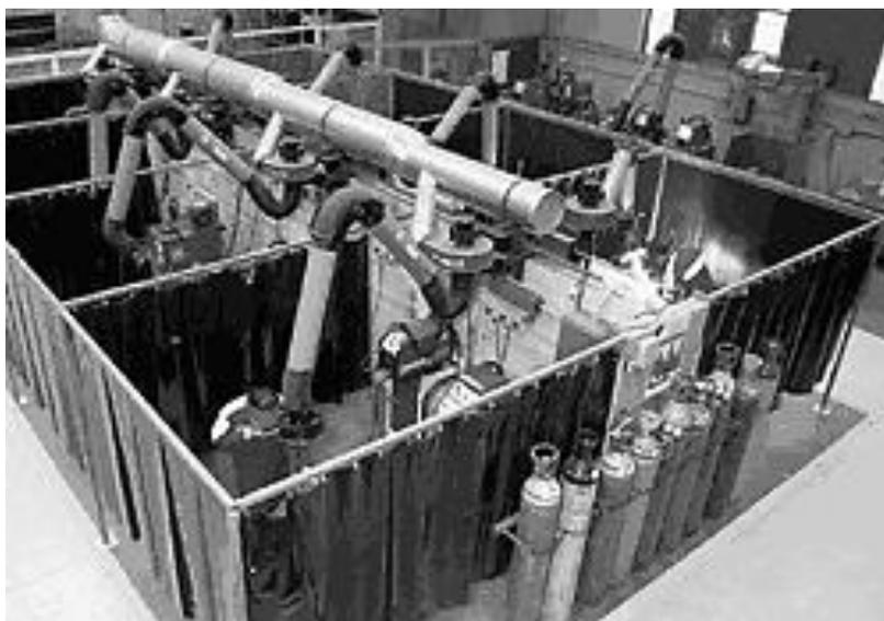
Рис. 4.4. Противопожарные экраны в виде огнезащитных штор
