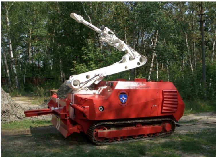
Рис. 7.102. Мобильный роботизированный комплекс пожаротушения среднего класса ЕЛЬ-4
