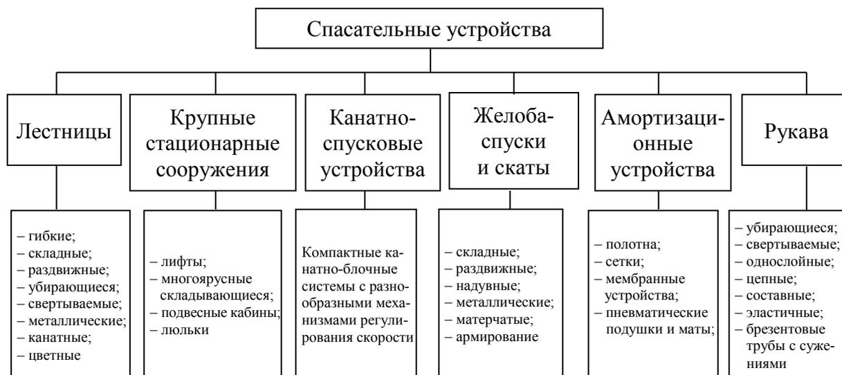
Рис. 8.19. Классификация спасательных устройств
