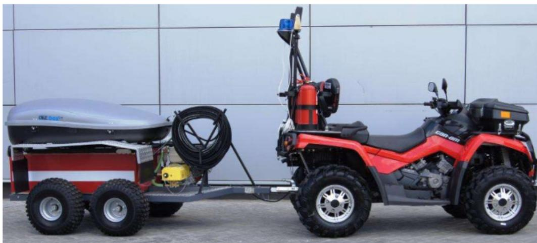
Рис. 7.116. Состав МВПС-У-П (пожарно-спасательного назначения)
