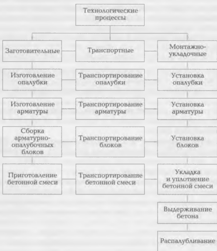
Рис. 11.1. Схема технологического процесса возведения монолитных железобетонных конструкций
