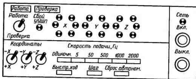
Рис. 17.47. Пульт контроля устройства управления шаговыми приводами
