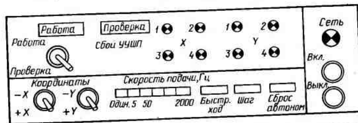
Рис. 17.41. Пульт контроля устройства управления шаговыми приводами
