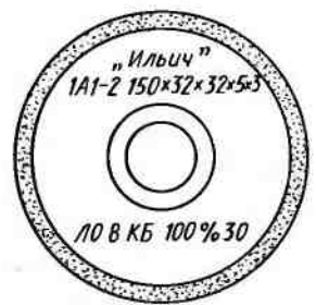
Рис. 13.7. Маркирование алмазного или эльборового шлифовального круга: «Ильич» — маркировка завода-изготовителя, 1A1-2 — обозначение формы круга, 150 — наружный диаметр, мм; 32 — высота круга, мм; 32 — диаметр посадочного отверстия, мм, 5 — ширина алмазного или эльборового слоя, мм, 3 — высота этого слоя, мм; ЛО — вид шлифовального материала, 8 — зернистость для эльборового круга (или 63/50 — для алмазного круга), КБ — связка, 100% — концентрация, 30 — число карат алмаза или эльбора в круге
