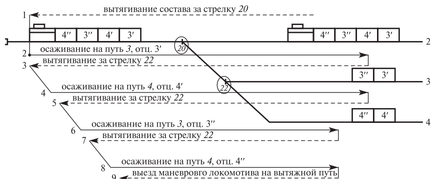
Рис. 3.5. Последовательность маневровых передвижений при расформировании состава со 2 пути способом осаживания
