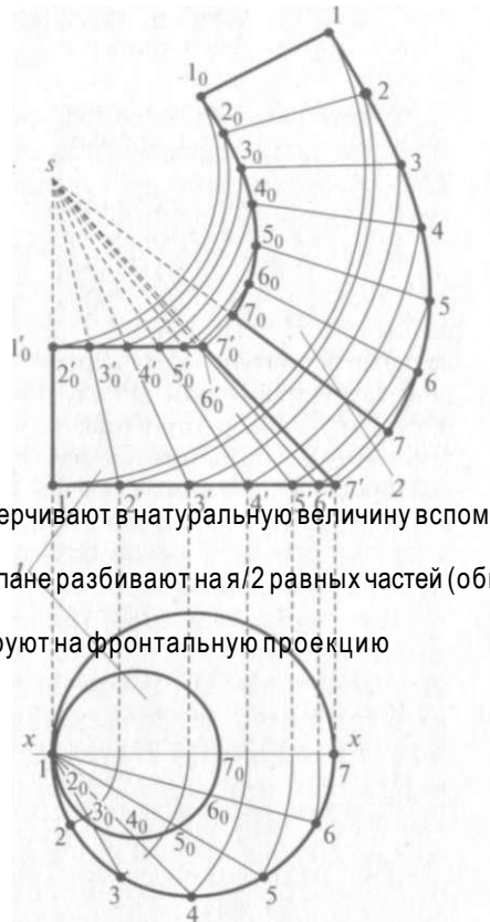
рис 3.9. Построение развертки сварного эксцентрического перехода:
