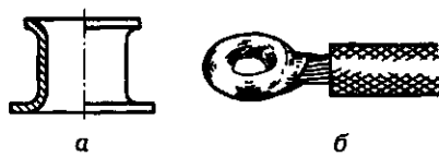
Рис. 3.14. Опрессовка многопроволочной медной жилы в кольцевом медном наконечнике:
