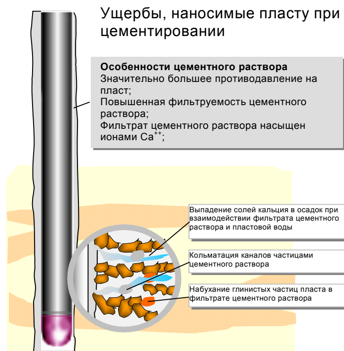
Рис. 1.7. Ущерб, наносимые пласту при цементировании
