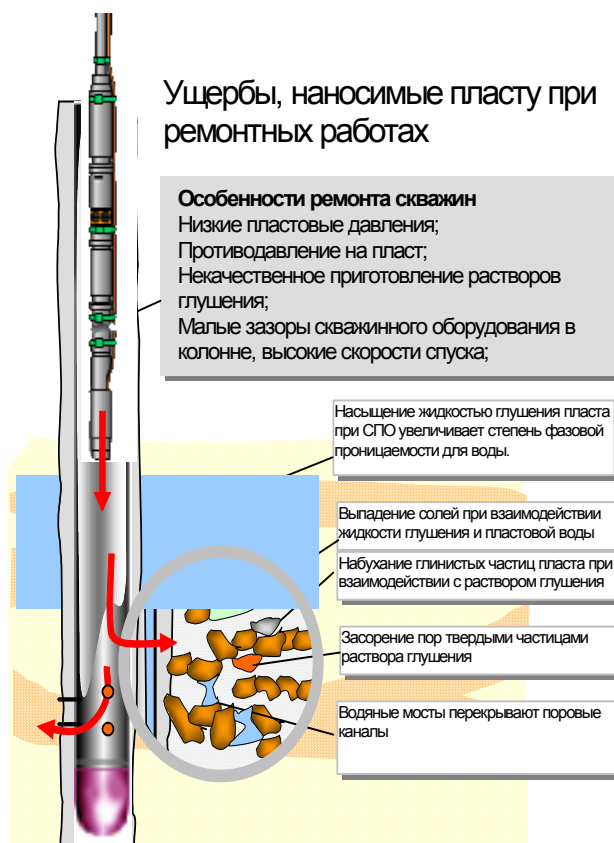
Рис. 1.11. Ущерб, наносимые пласту при ремонте
