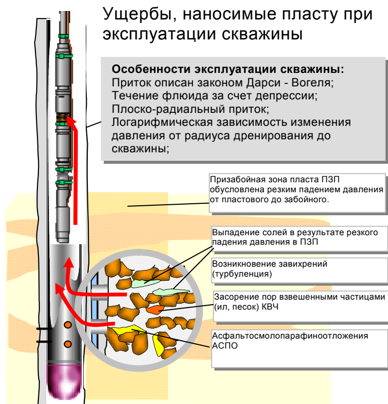
Рис. 1.12. Ущерб, наносимый пласту при эксплуатации скважины
