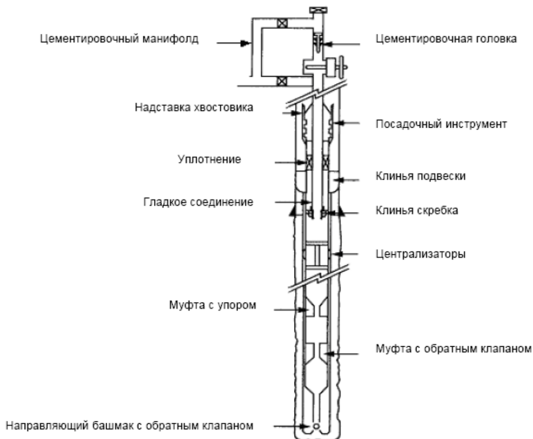
Рис. 9.5. Технология спуска хвостовика
