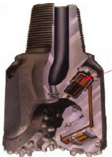
Рис. 4.4. Схема долота с герметизированной маслonaполненной опорой
