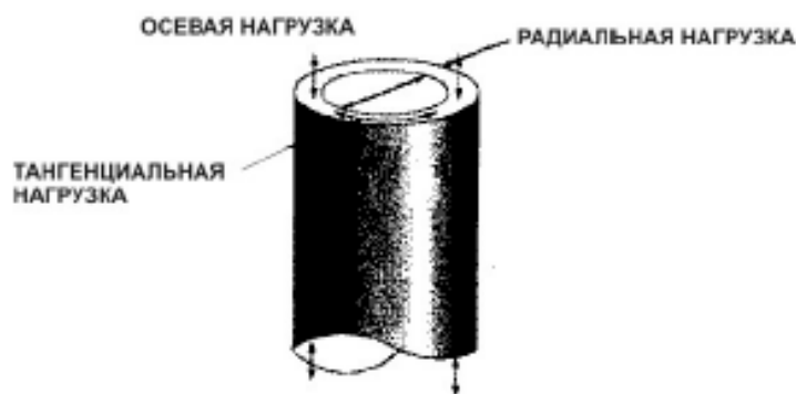
Рис. 9.9. Трехосная нагрузка на обсадную колонну
