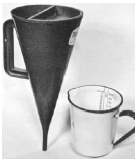
Рис. 6.10. Воронка МАРША для определения условной вязкости
