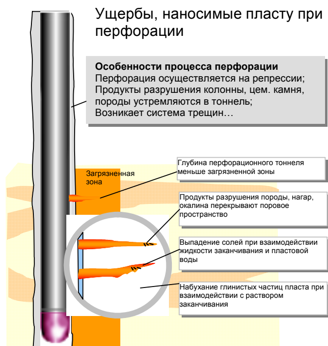
Рис. 1.10. Ущерб, наносимый пласту при перфорации
