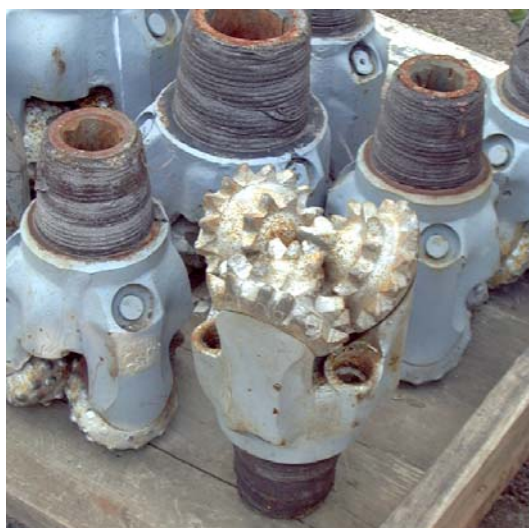
Рис. 4.5. Виды вооружения шарошечных долот (вставные и цельные зубья)
