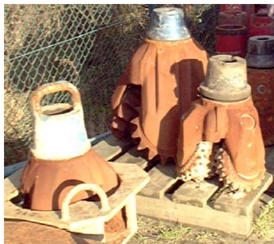
Рис. 4.5. Виды вооружения шарошечных долот (вставные и цельные зубья)
