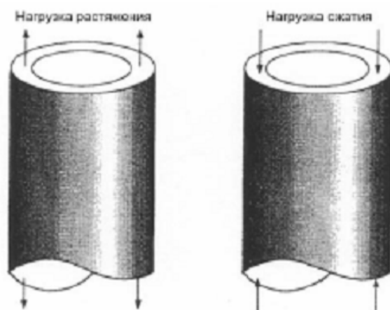
Рис. 9.8. Продольные нагрузки на обсадную колонну
