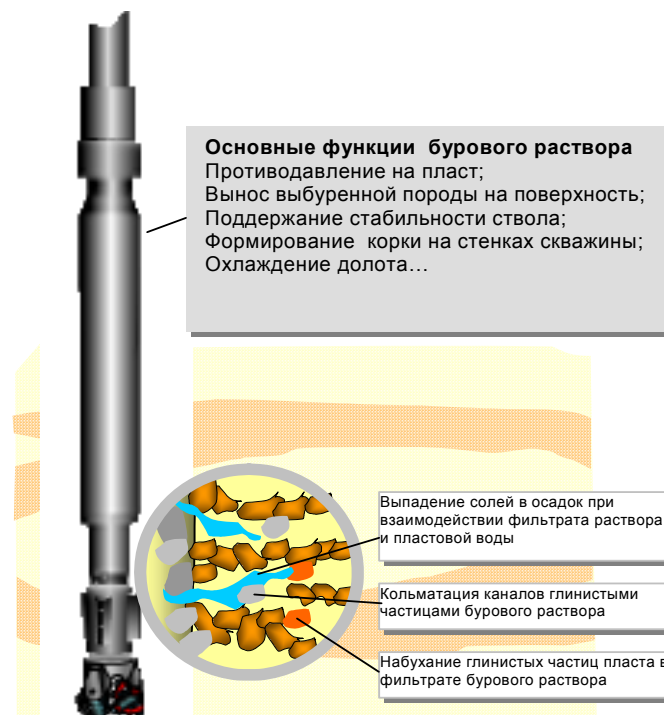
Рис. 1.6. Основные функции бурового раствора и возможные ущербы пласту при бурении
