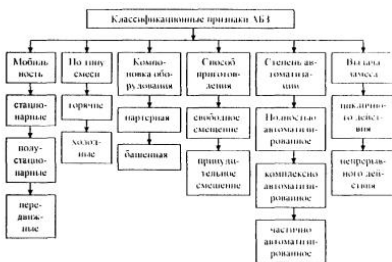
Рис. 7.4.1. Классификация асфальтобетонных заводов
